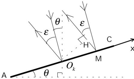
Il faut déjà calculer la différence de marche entre un rayon diffracté en un point courant M et un rayon diffracté au centre de la bande AC.
