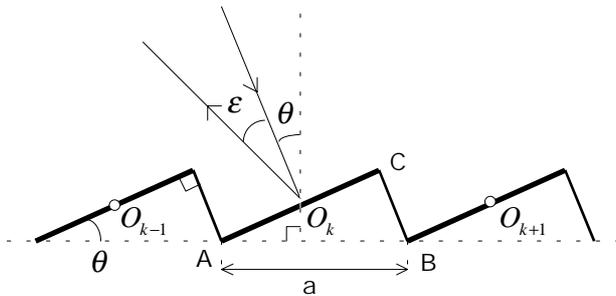
Un réseau "échelette" par **réflexion** est constitué de  $N$  bandes réfléchissantes de faible largeur  $AC$  par rapport à leur dimension perpendiculaire au plan de la figure. Ces bandes sont inclinées par rapport au plan du réseau, de pas  $a=AB$ . Les bandes de type  $BC$  sont non réfléchissantes.
